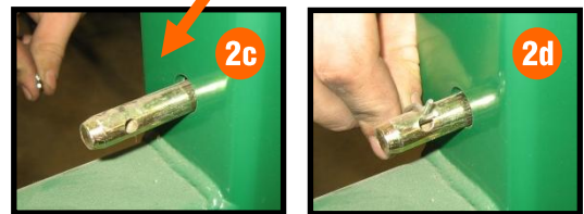
Rahmen-Sicherungsstift einsetzen, mit Splintbolzen sichern
