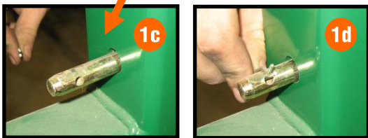
Rahmen-Sicherungsstift einsetzen, mit Splintbolzen sichern
