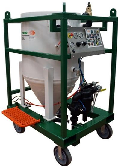
Diese funktionsreiche Feed Unit ist eine größere Ausführung unseres beliebtesten Einspeisungsmoduls mit bis zu zweieinhalb Stunden ununterbrochener Strahldauer bis zur Wiederauffüllung.
